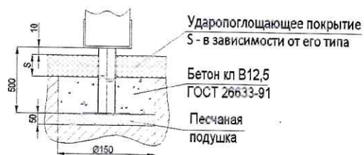
Схема установки закладной
