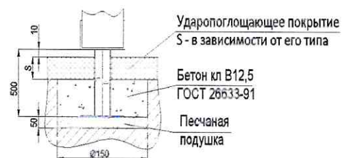
Схема установки закладной
