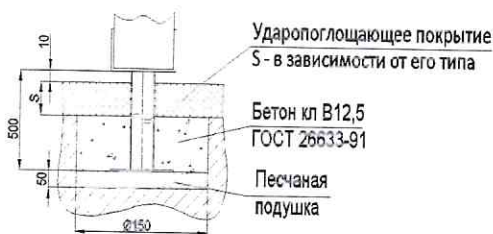
Схема установки закладной
