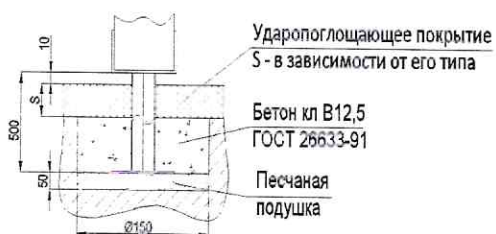
Схема установки закладной
