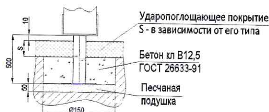
Схема установки закладной
